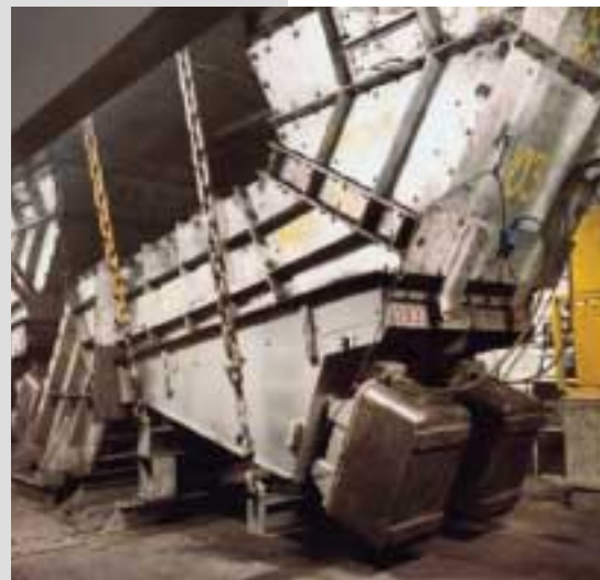
Selbst unter Tage ist der Abzug aus Vorratsbunkern mit explosions- und schlagwettergeschützten Antrieben möglich. Großgeräte können in Segmente zerlegt unter Tage gebracht werden
