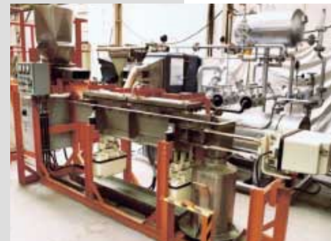
Im Vibrationsfließbett läuft z. B. Kunststoffgranulat über ein Mikrosieb. Heiße Luft trocknet exakt auf die vorgegebene Restfeuchte. Ein Regelkreis steuert die Fließgeschwindigkeit in Abhängigkeit vom Trocknungsgrad durch einfache Spannungsregelung der Antriebe
