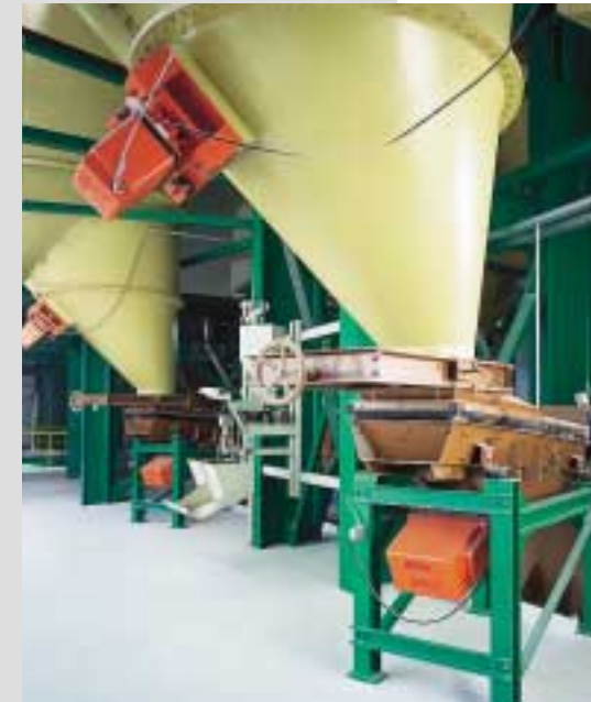
Kontinuierliches Chargieren von Glasgemenge-Komponenten und das Eintragen in die Schmelzwanne erfolgt durch feinsteuerbare Förderrinnen mit wartungsfreien Magnetantrieben. Zusätzliche Stoßrüttler an den Bunkerwänden verhindern Festsetzen und Brückenbildung
