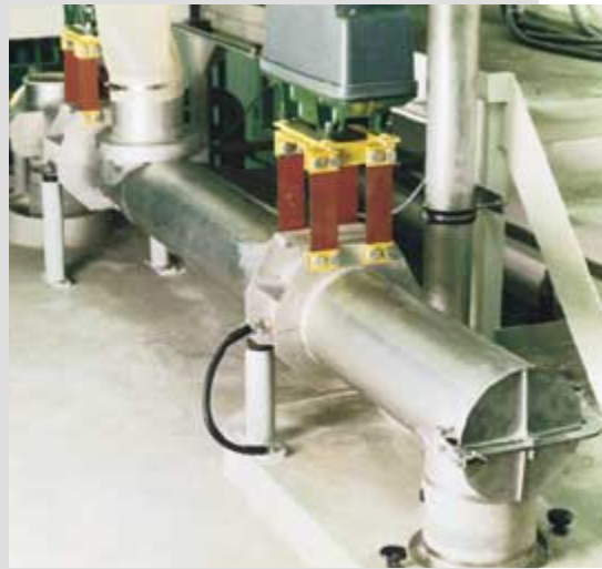
Ein reversierbares Förderrohr verteilt Milchpulver abwechselnd in zwei Richtungen. Die 100%ige Umleitung des Förderstromes erfolgt durch elektrisches Umschalten ohne aufwendige Klappenmechanismen
