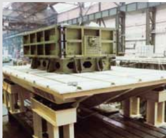
Vibriertische mit stufenlos regelbaren Magnetvibratoren sorgen für perfekte Materialverdichtung in der Produktion und beim Verpacken
