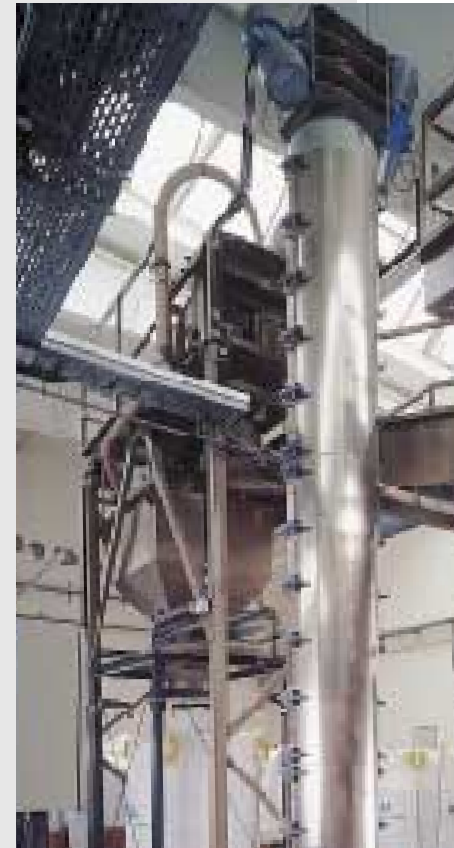
PVC Granulat muß auf engstem Raum große Höhendifferenzen überwinden, Wendelförderer bieten neben der Transportfunktion zusätzliche Möglichkeiten das Fördergut verfahrenstechnisch zu behandeln
