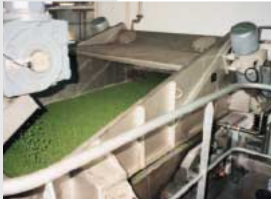
Für die Gemüseverarbeitung werden Förderrinnen, -rohre und Siebe eingesetzt, die speziell nach den hohen Hygienestandards der Lebensmittelindustrie ausgelegt sind
