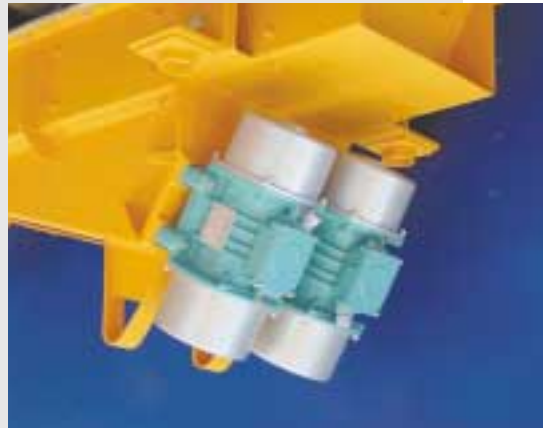
Förderrinnen zur Beschickung eines Becherwerkes mit 12 m 3 /h Glasgemenge
