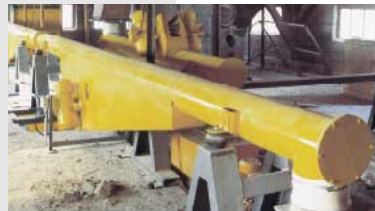
Gekapselte Förderung schützt vor unerwünschten Verunreinigungen des Fördergutes und der Umgebung
